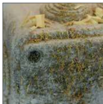
Grado IP6X per la protezione totale dalle polveri IP6X degree for protection against dust
