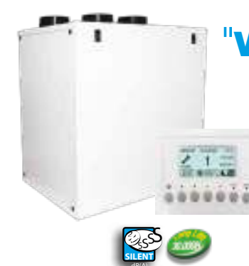
VNRV550ECPN Unità ventilante centralizzata a doppio flusso per installazione a parete in posizione verticale per ambienti con superficie sino a 385 m² portata massima 550 m³/h
