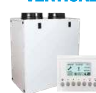
VNRV280ECPN Unità ventilante centralizzata a doppio flusso per installazione a parete in posizione verticale per ambienti con superficie sino a 190 m² portata massima 281 m³/h
