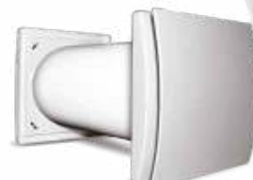
VNDR150EC Unità ventilante decentralizzata a singolo flusso alternato con recupero di calore per ambienti con superficie sino a 45 m² portata massima 60 m³/h
